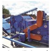
cación de MDF. La línea de astillado está diseñada para procesar hasta 60 toneladas de madera seca por hora.
