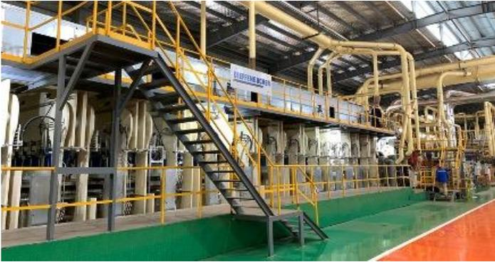
ALEMANIA - Con la construcción de una prensa CPS+ de 80 metros de largo, Dieffenbacher establecerá un récord mundial para la prensa continua más larga utilizada para producir paneles a base de madera. Esta prensa es el componente central de una planta de MDF encargada a Dieffenbacher en julio por el fabricante chino de paneles de madera Guangxi Lelin Forestry Development Co, Ltd.
