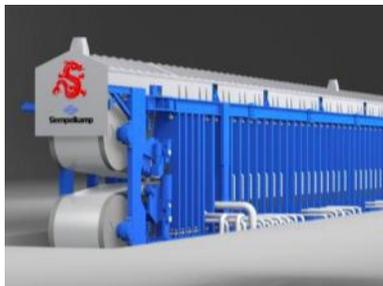
Con la nueva Dragon Press de Siempelkamp, una prensa de 4 pies ContiRoll®, los productores de tableros estarán en capacidad de proporcionar una amplia gama de productos con la misma calidad Siempelkamp a un precio atractivo. El cabezal de alimentación flexible de la ContiRoll® permite la producción de tableros de aglomerado, MDF y OSB con un espesor que oscila entre 2 y 40 mm. Este tipo de prensa más pequeña también permite la producción de tableros delgados de alta calidad.
