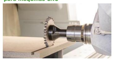
ALEMANIA - <u>Leuco</u> ofrece la primera ranura con un ancho de corte de 8.5 mm para máquinas CNC. Hasta ahora, este ancho a menudo solo se lograba con una ranura de 5 mm en dos pasos de trabajo. Esta innovación de Leuco ahora acelera el ritmo y la vida útil de la herramienta también se duplica.
