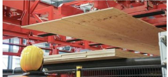
EE. UU. - [Freres Lumber Co., Inc.](#) es la primera empresa de EE. UU. en instalar y operar la prensa horizontal [Taihei modelo P25-AB](#), una prensa caliente horizontal para laminar madera contrachapada después de los procesos de encolado y preensado. De acuerdo con su historia como líder en adopción temprana e innovación, Freres ya está cosechando los numerosos beneficios que ofrece la prensa horizontal sobre la tecnología de prensa vertical convencional de EE. UU.
