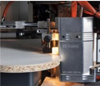
en la fusión de una capa reactiva utilizando lámparas de infrarrojos. La falta del hilo de cola garantiza la continuidad de la superficie del panel y su
