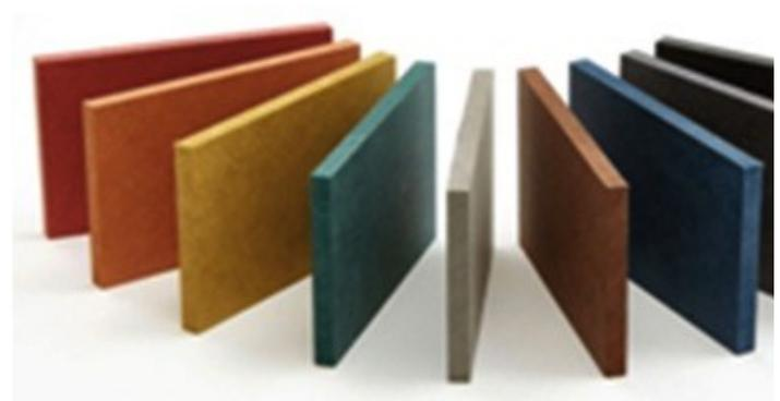
Este particular tablero MDF ofrece una alta resistencia a la humedad debido al alto contenido de melamina en su resina, lo que lo hace apto para ser aplicado con el acabado correcto en baños y cocinas. El color en todo su espesor se logra mediante colorantes orgánicos, lo que le otorgan la certificación coreana E0 en emisión de formaldehído. Estos paneles ostentan también las certificaciones CARB y FSC.
